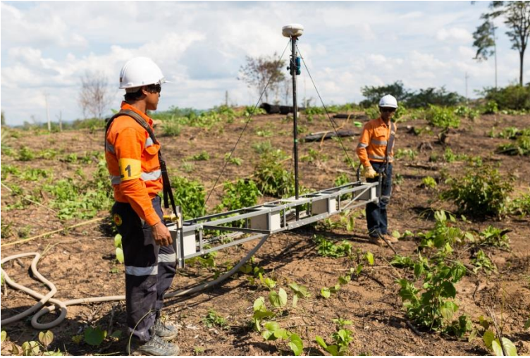
ຮູບ 1 – ນັກວິຊາການກວດ-ເກັບກູ້ UXO ຂອງ ບໍລິສັດ LXML ພວມນຳໃຊ້ອຸປະກອນທັນສະໄໝ UltraTEM ເພື່ອ ຄົ້ນຫາລູກລະເບີດບໍ່ທັນແຕກໃນລະດັບຄວາມເລິກເຖິງ 3,5 ແມັດ ທີ່ ບໍ່ຄຳ-ທອງ ເຊໂປນ. (Photo credit: Photo©MMG)
